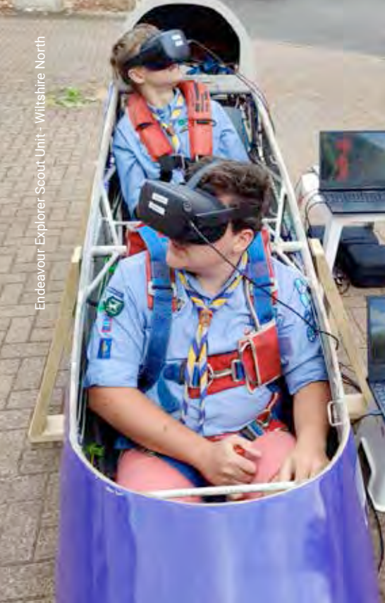
Simulatore di volo realizzato dagli Endeavour Explorer di Chippenham (UK) in grado di far "volare" due piloti contemporaneamente nella scocca di un aliante dismesso https://endeavouresu.uk/glider-simulator-videos/
