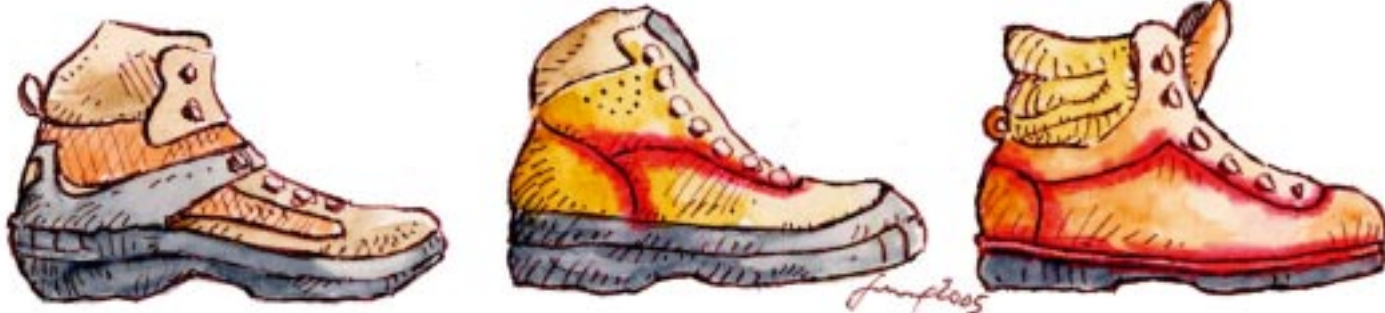
FIG. 1 - Sono evidenziati in rosso i punti a critica tenuta d'acqua
