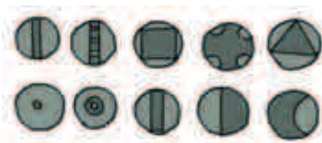
FIG.4 Teste di chiodo sagomate
